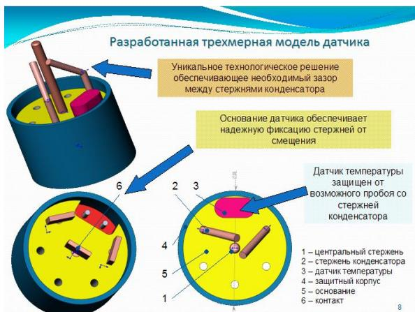
**Рис. 2. Конструктивное решение универсального датчика**
